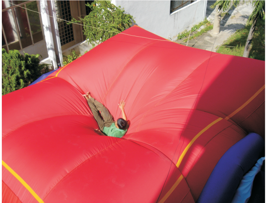
Thử nghiệm đệm hơi cứu hộ 7T tại Viện Kỹ thuật nhiệt đới và Bảo vệ môi trường TP.HCM
