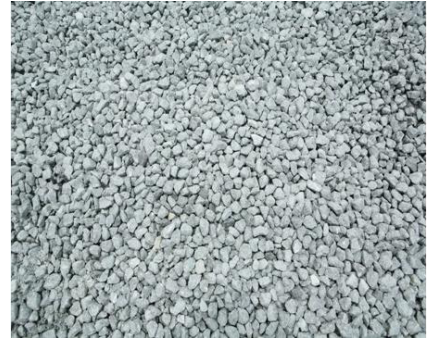
Đá dăm chất lượng cao do máy nghiền Titan D-160 sản xuất
