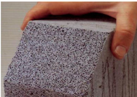
Bê tông siêu nhẹ nhờ cấu trúc lỗ rỗng chứa khí bên trong
